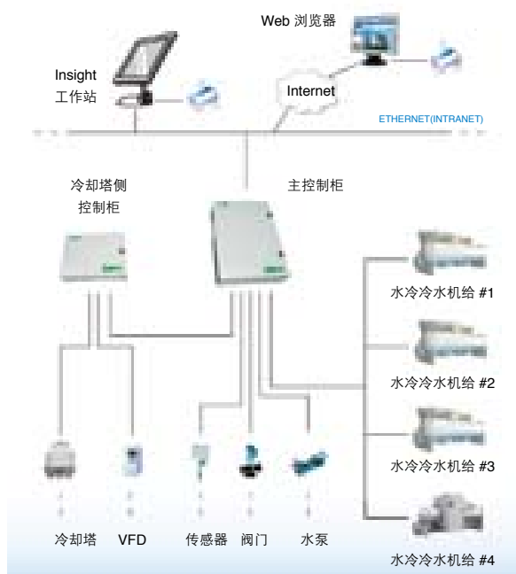
水冷冷水机组系统联网示意图
