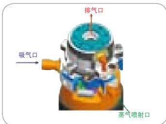
EVI 压缩机结构图
